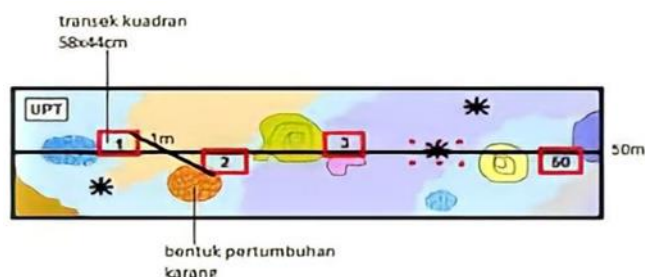
Gambar 2. Ilustrasi contoh pengambilan data menggunakan metode Underwater Photo Transect (Sumber: Giyanto, 2012).
